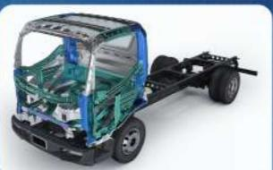
**ĐẦU CABIN LẮT** làm bằng thép cường độ cao, được nhúng ED toàn phần, tăng khả năng chịu lực và độ chống ăn mòn.
